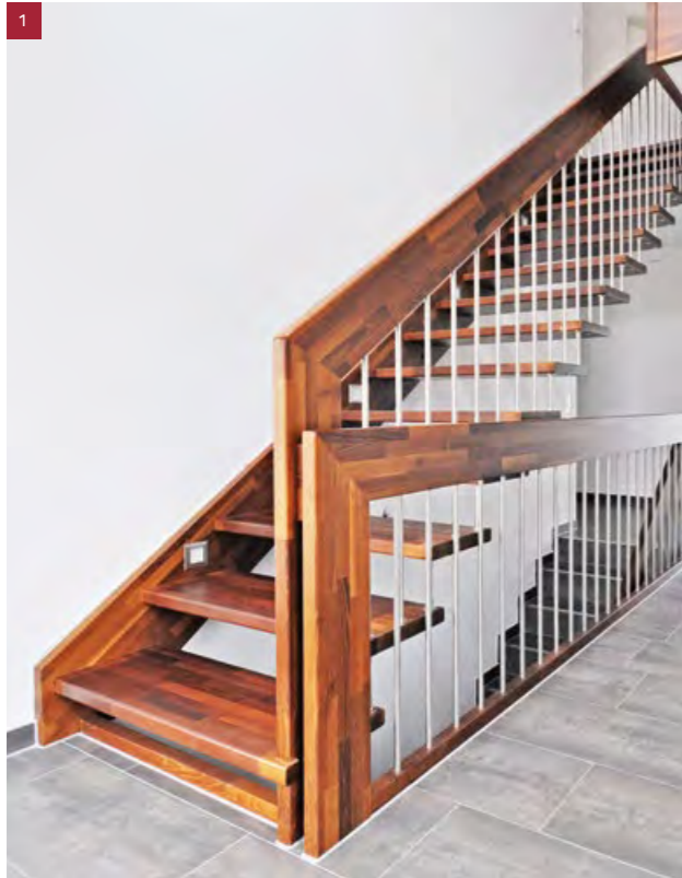
1 Gerade Bolzentreppe in Nussbaum keilgezinkt, mit Wandwange, senkrechte Geländerstäbe in Edelstahl, LED-Leuchten in Wandwange, Pfosten und Handlauf eckig
