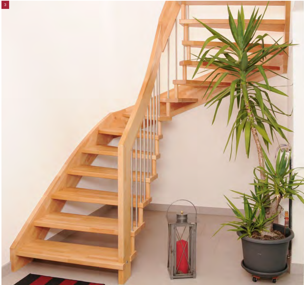
1/2-gewendelte Bolzentreppe in Buche keilgezinkt, mit Wandwange, senkrechte Geländerstäbe in Edelstahl, Pfosten und Handlauf eckig
