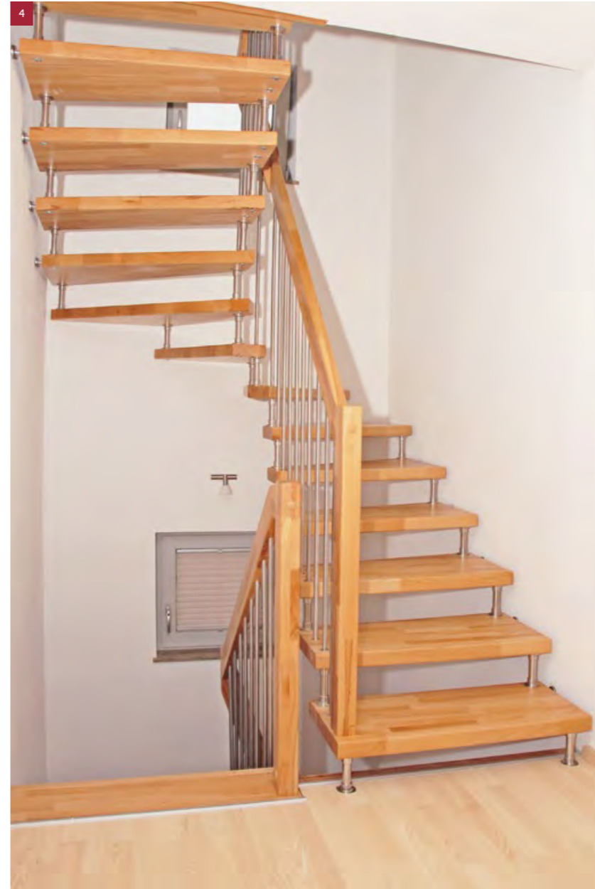
4 Bolzentreppe in Buche keilgezinkt, mit Wandbolzen, Stufenbolzen und Wand- rosetten in Edelstahl. Handlauf eckig
