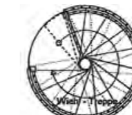
Spindeltreppe rund (rechts) und Deckenloch rund, von 145 bis 250 cm Durchmesser
