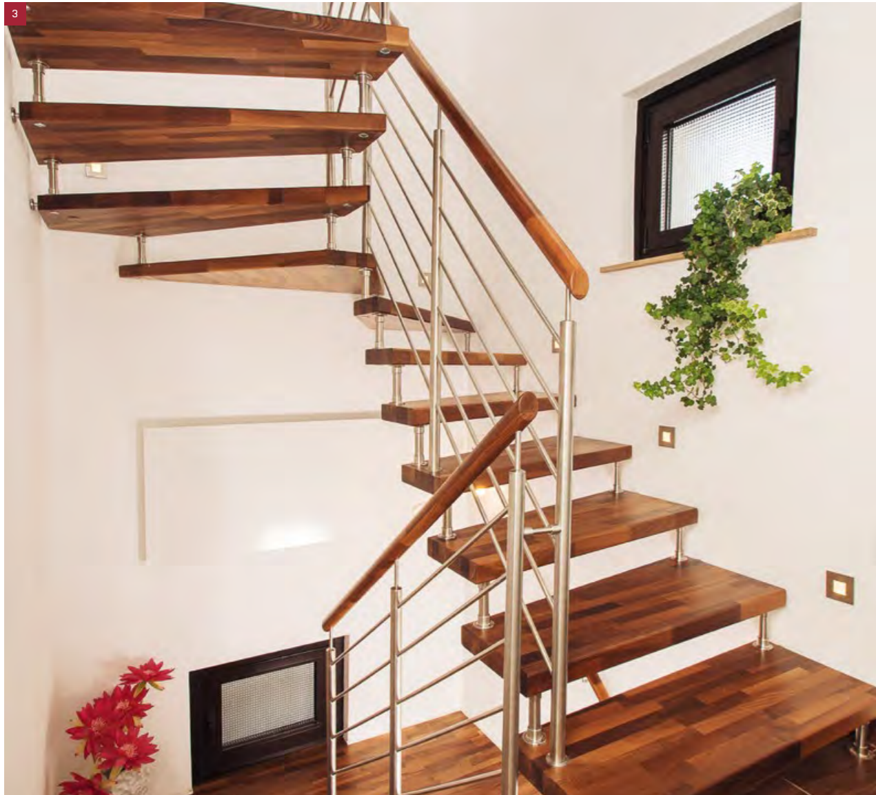
3 1/2-gewendelte Bolzentreppe in Nussbaum keilgezinkt, mit Wandbolzen. Geländer und Stufenbolzen in Edelstahl. Rundhandlauf
