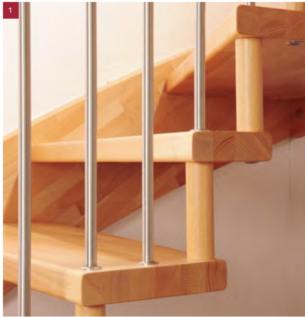
Detailansicht Distanzhülsen in Holz und senkrechte Geländerstäbe in Edelstahl (1/2-gewendelte Bolzentreppe in Buche keilgezinkt)
