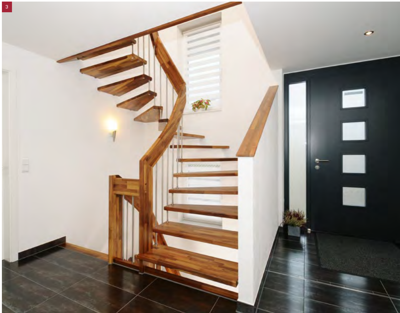
3 1/2-gewendelte Bolzentreppe in Nussbaum keilgezinkt, senkrechte Geländerstäbe in Edelstahl, Pfosten und Handlauf eckig
